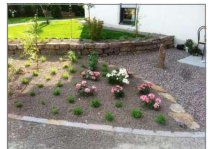
Rötlicher Porphyrschotter in verschiedenen Körnungen: 40/70 mm, 15/30 mm, 11/22 mm, 0/15 mm usw. Der Porphyrschotter eignet sich für Gartengestaltungen und auch für Drainagen und den Straßenunterbau.
